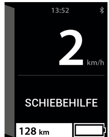
Abbildung 2: Schiebehilfe aktiviert aber nicht aktiv
